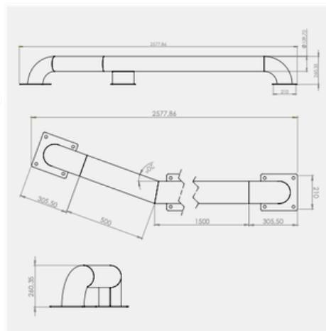
Los **tubos de guiado abiertos** facilitan el iniciado de maniobra del camión, estrechándose en su parte media/trasera para el guiado definitivo del mismo hasta el muelle.
